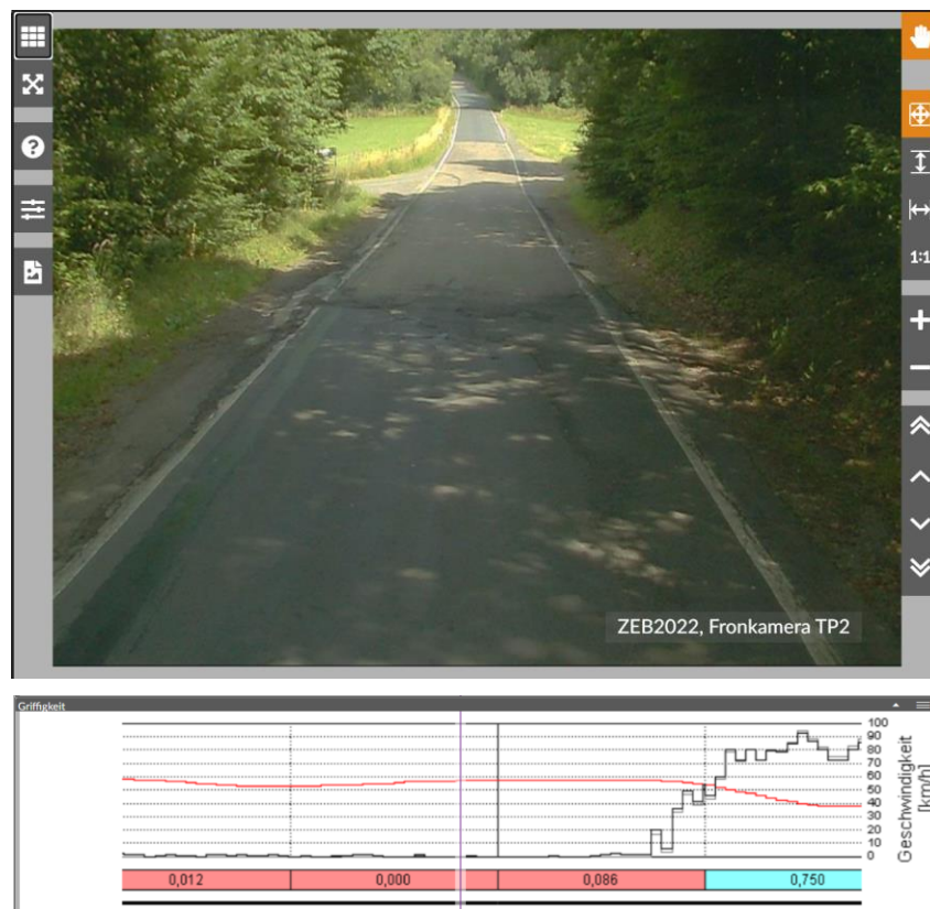
Bild 32 Beispiel für einen Bereich mit angehobenem Messrad ohne Kennzeichnung der Daten
