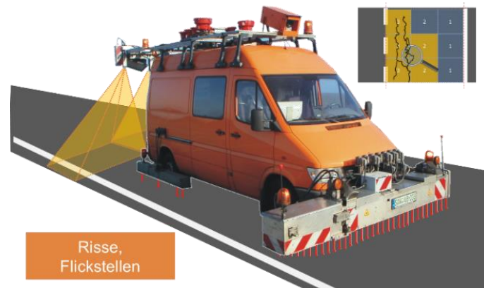
Bild 6 Messsystem zur Erfassung der Substanzmerkmale, IFI Consult GmbH
