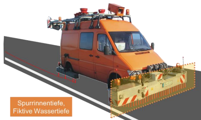
Bild 4 Messsystem zur Erfassung der Querebenheit, IFI Consult GmbH
