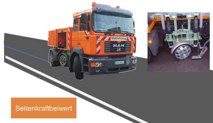
Bild 5 Messsystem (Seitenkraftmessverfahren) zur Erfassung der Griffigkeit, IFI Consult GmbH
