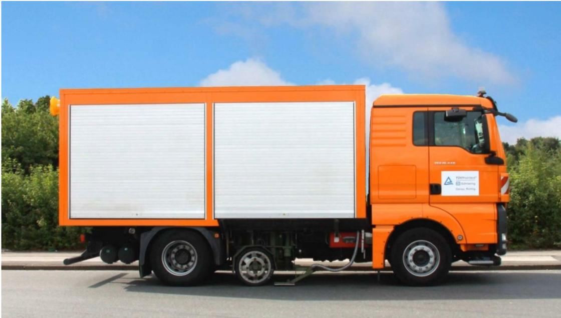
Abb. 2: Messfahrzeug der Fa. TÜV Rheinland Schniering GmbH für TP 2 (SKM)
