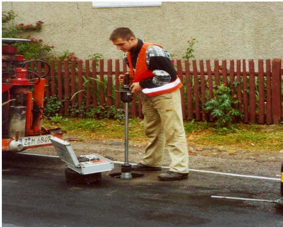
Bild 44 Tragfähigkeitsmessung mit Leichtem Fallgewichtsgerät in Bohrloch
