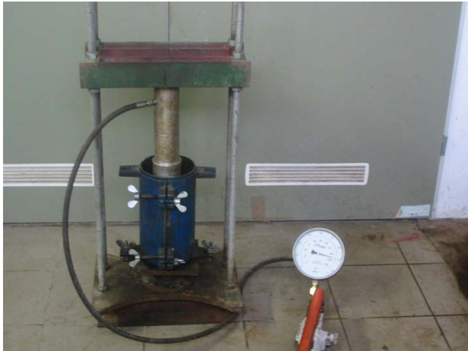
Bild 99 Druckvorrichtung für Labor und Baustelle zur Herstellung von KRC-Probekörpern mit Probekörperform -- Krafterzeugung mittels Hydraulik-Handpumpe (Plattendruckversuch)
