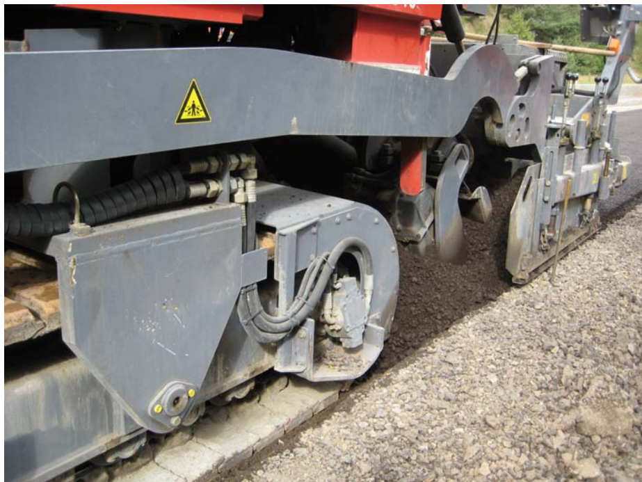
Bild 1313 Wirtgen-Recycler WR 4200 - Detail KRC-Mischgut vor Verteiler-schnecke und Einbaubohle
