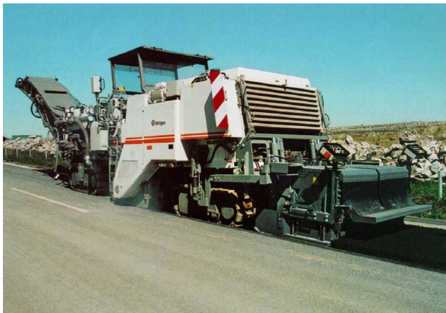
Bild 1515 Wirtgen-Recycler 2200 CR - Recycler mit Fräsrotormischer
