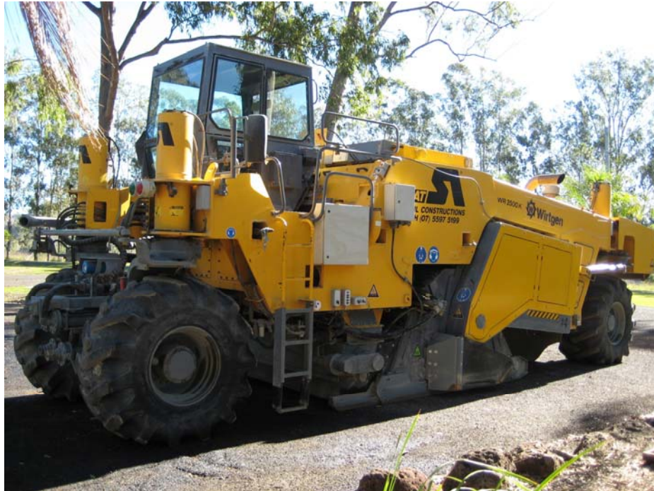
Bild 1616 Wirtgen-Fräsrecycler WR 2500 K - Arbeitsbreite 2.438 mm
