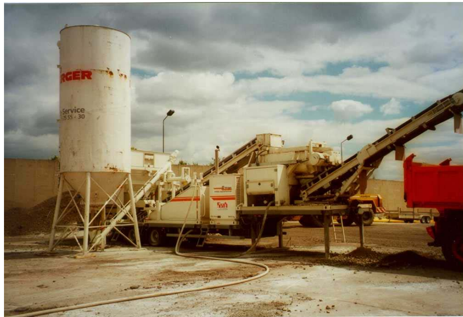
Bild 2424 Wirtgen-Kaltmischanlage KMA 150 in Arbeitsstellung
