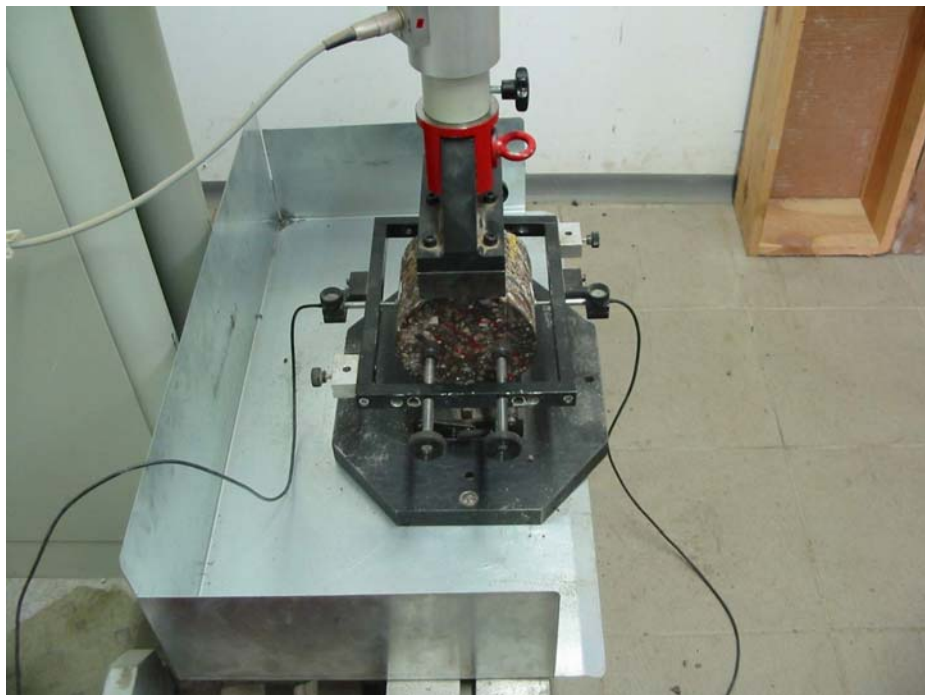
Bild 1010 KRC-Probekörper mit \varnothing 150 mm und H \approx 125 mm in Prüfvorrichtung zur Spaltzugprüfung mit Querdehnungsmessung
