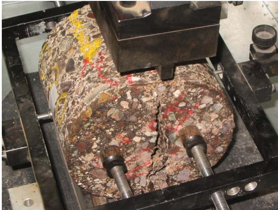
Bild 1111 KRC-Probekörper mit \varnothing 150 mm und H \approx 125 mm in Prüfvorrichtung zur Spaltzugprüfung mit Querdehnungsmessung nach der Prüfung
