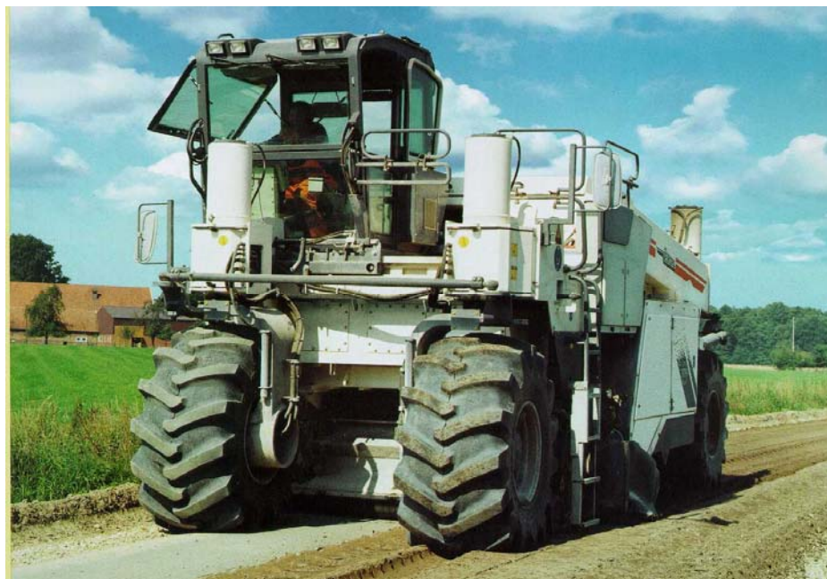
Bild 1717 Wirtgen-Fräsrecycler WR 2500 S - Arbeitsbreite 2.438 mm
