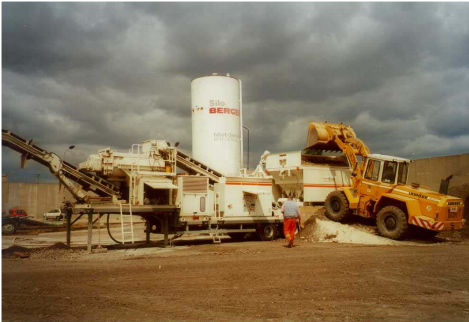
Bild 2323 Wirtgen-Kaltmischanlage KMA 150 in Arbeitsstellung
