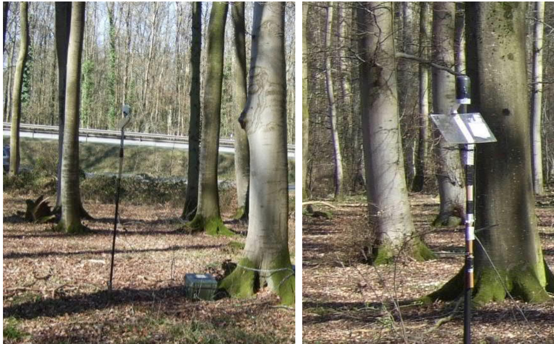
Abbildung 11: Aufbau eines Anabat-Systems an Standort B1 (straßennah). Im Hintergrund sind die Leitplanken der B 51 zu erkennen.
