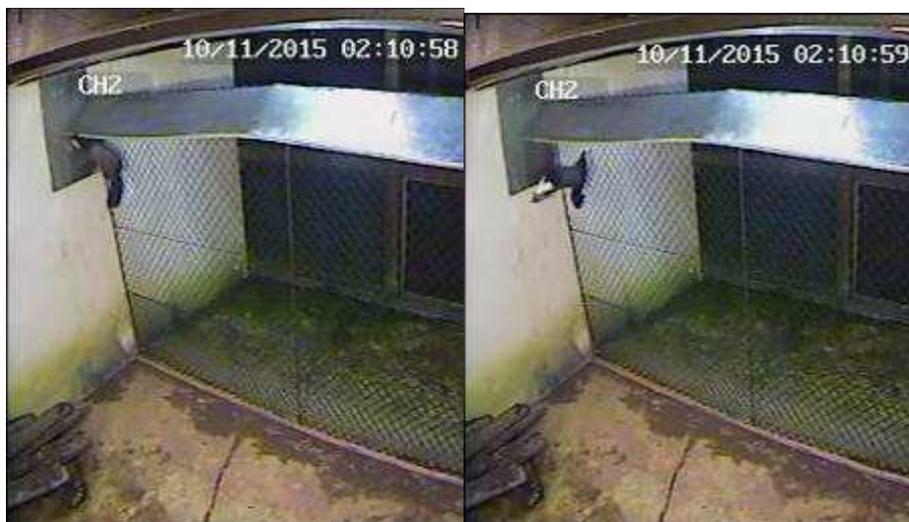
Abb. 43: Zaunvariante A 60 mit Wandverkleidung– das Steinmarderweibchen rutscht bei dem Versuch, den Zaun trotz Wandverkleidung zu überwinden ab und fällt.
