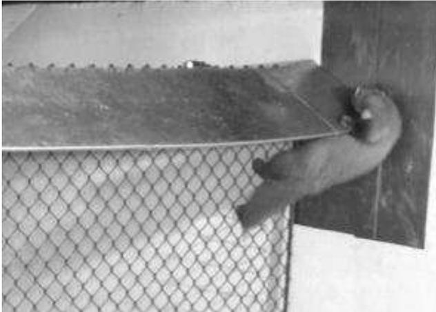
Abb. 41: Zaun Grundtyp A 60 mit Wandverkleidung – das Steinmarderweibchen zieht sich in der schmalen Spalte zwischen Überhangsblech und Wandverkleidung hoch.
