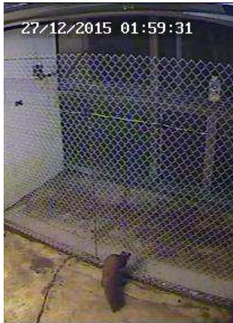
Abb. 40: Maschendraht 3 mm ohne Ummantelung. Das Baumarderweibchen steckt seinen Kopf durch eine Masche, kommt aber nicht weiter.
