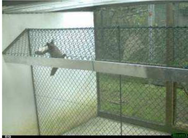
Abb. 29: Zaunvariante A 48 mit zusätzlichem hängendem Blech.
